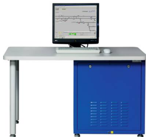
Автоматизированное рабочее место электромеханика АРМ ШН
