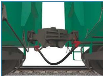
Системы автоматического контроля механизма автосцепки
