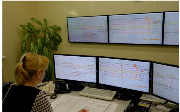
ООО «УГМК-Холдинг», железнодорожная инфраструктура ОАО «СУМЗ». Для увеличения пропускной способности станции, расположенной на расстоянии более 8 км, с помощью ББК-02 организовано удаленное управление и контроль по ВОЛС ЭССО-М, стрелочными приводами и светофорами.
