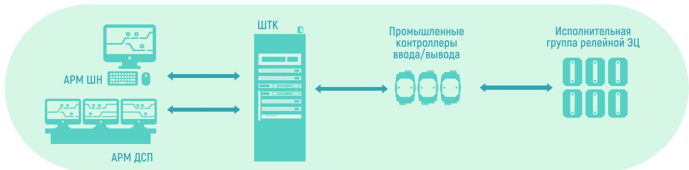
МПЦ-И с релейно-контактным интерфейсом
