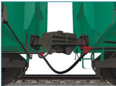
Системы автоматического контроля механизма автосцепки
