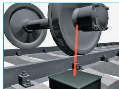
Позиционирование в системах контроля нагрева брук
