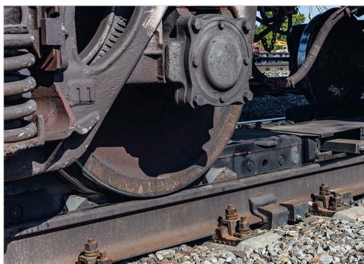
Закрепление состава тормозным упором КТС АЗС на станции Билимбай Свердловской дороги
