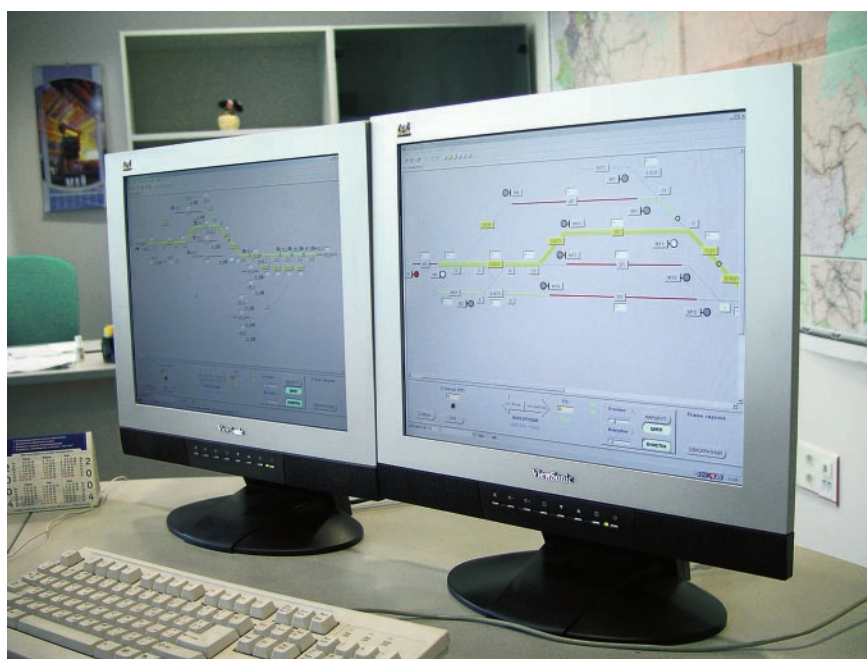
Рис. 3. АРМ дежурного по станции в МПЦ-И
