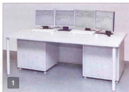
1. Автоматизированное рабочее место дежурного по станции (система МПЦ-И) 2. Постовое оборудование системы МПЦ-И
