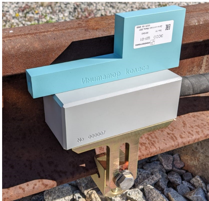
Рисунок 4 – Установка имитатора колеса на ДКЛ
