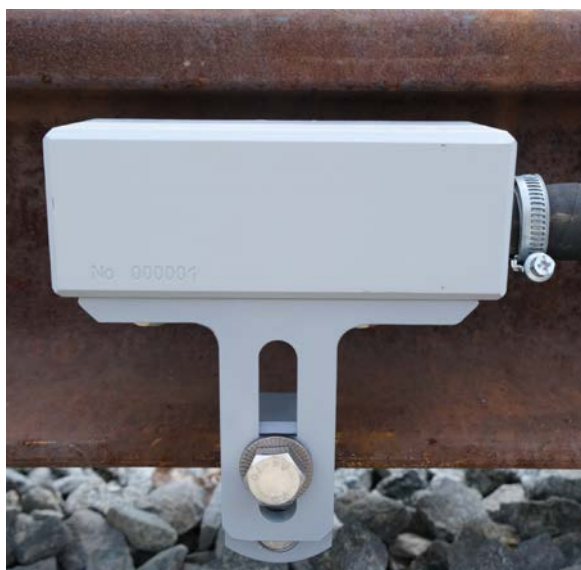
Рисунок 1 – Внешний вид ДКЛ с креплением ККД-Л
