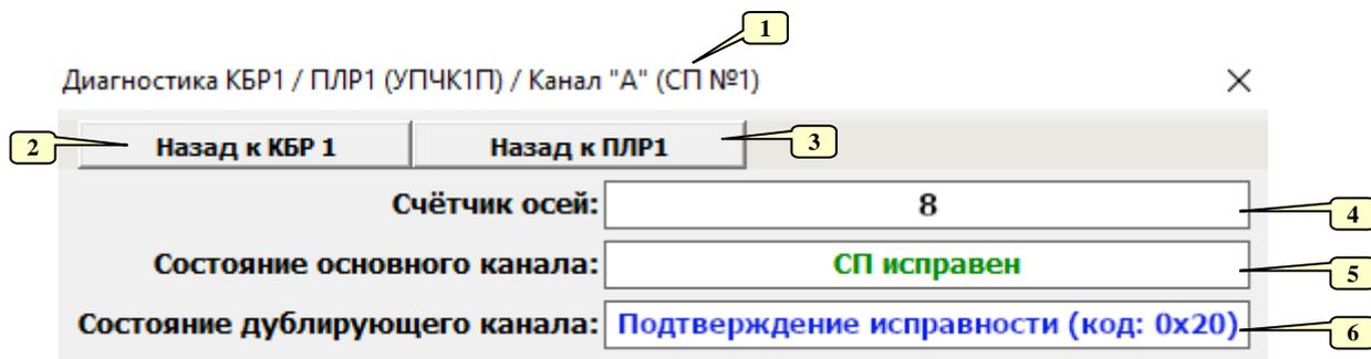
Рисунок 7.34 – Диагностическая информация о состоянии канала ПЛР
