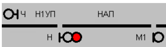
Рисунок 4.9 – Элементы индикации увязки с перегоном без проходных светофоров
