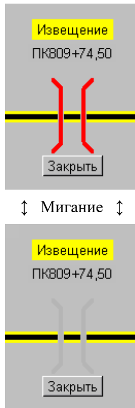
Рисунок 9.3 – Индикация автоматической подачи извещения на закрытие переезда
