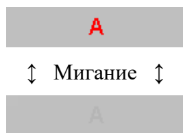
Рисунок 9.6 – Индикация аварии в релейном шкафу переезда
