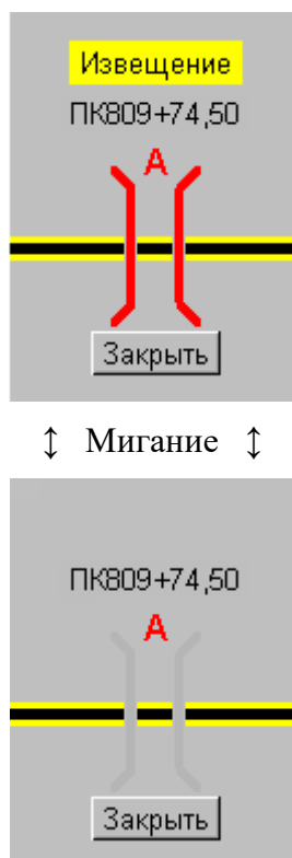
Рисунок 9.5 – Индикация автоматической подачи извещения
