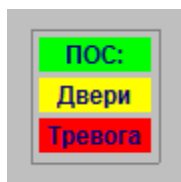
Рисунок 10.1 – Элементы контроля состояния устройств системы пожарно-охранной сигнализации
