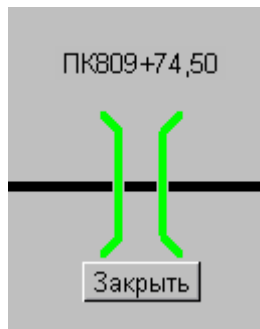
Рисунок 9.2 – Индикация переезда в открытом и исправном состоянии
