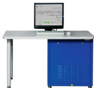
Автоматизированное рабочее место электромеханика АРМ ШН
